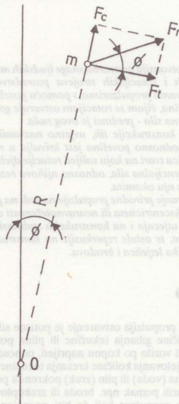
Slika 1. Djelovanje centrifugalne sile ( F_c ) i tangencijalne sile ( F_t ) odnosno rezultatne sile ( F_r ) na česticu ( m ) koja rotira oko osovine (0) na udaljenost ( R )
