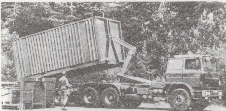
Slika 2. Vozilo Renault G 290,26 (6x4), iz programa VTL, utovari standardni ISO (DIN 30722) kontejner od 20 ft s pomoću uređaja za samoutovar/istovar tipa Bennes Ampliroll
