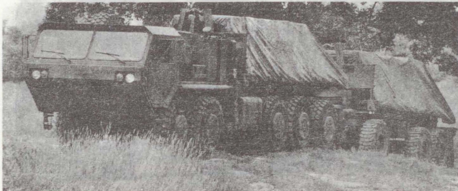
Slika 6. Sustav M-1076 sastavljen od vozila Oshkosh 10x10 (SAD), prikolice LOHR RM-22 (Francuska), uređaja za samoutovar Mark 5 (Velika Britanija) i odgovarajuće platforme
